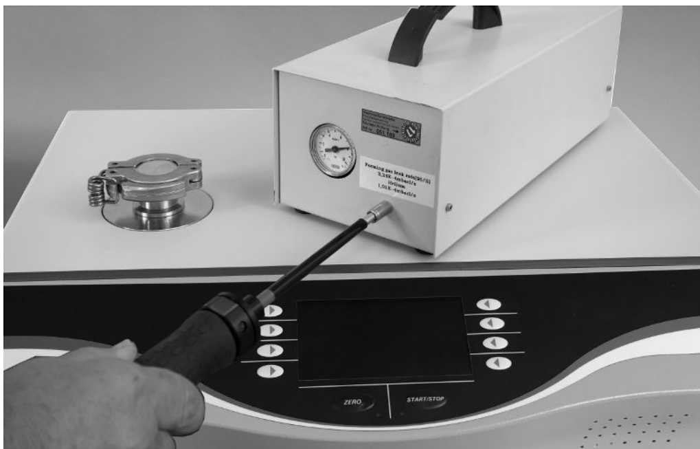
Abb. 12: Schnüffelprüfung am externen Prüfleck
