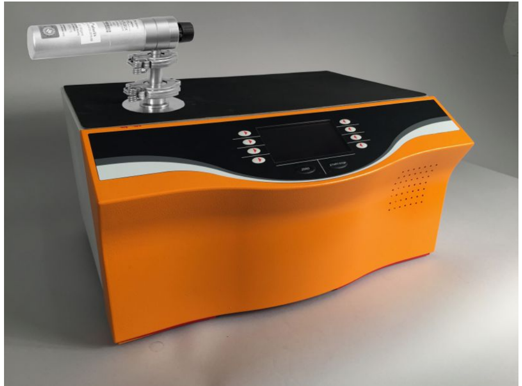
Abb. 10: Externes Prüflack prüfen
