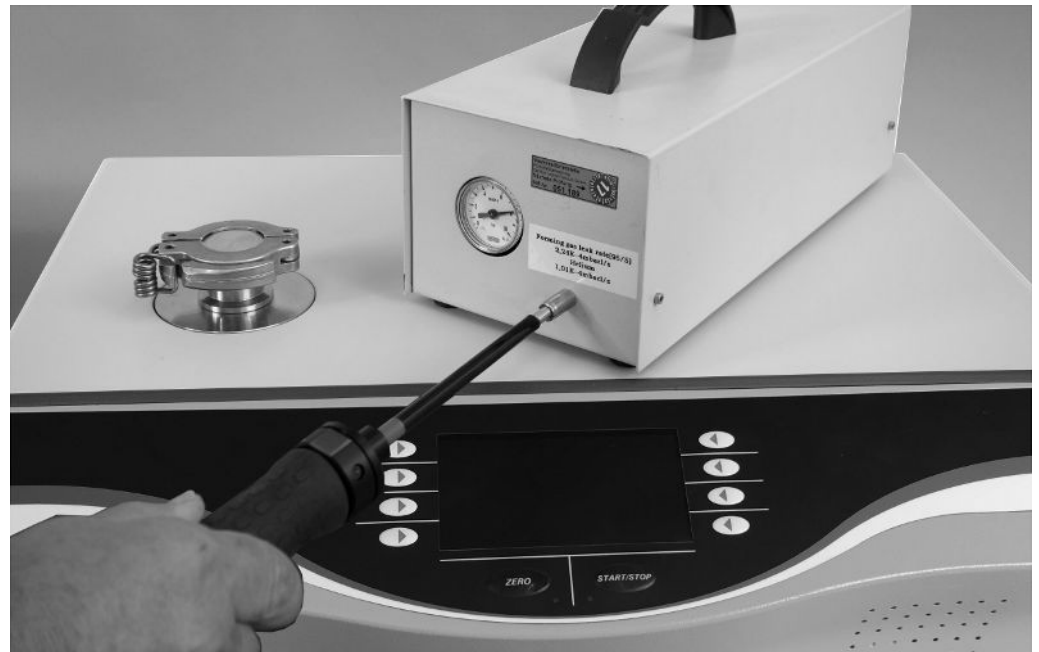
Abb. 12: Schnüffelprüfung am externen Prüfleck
