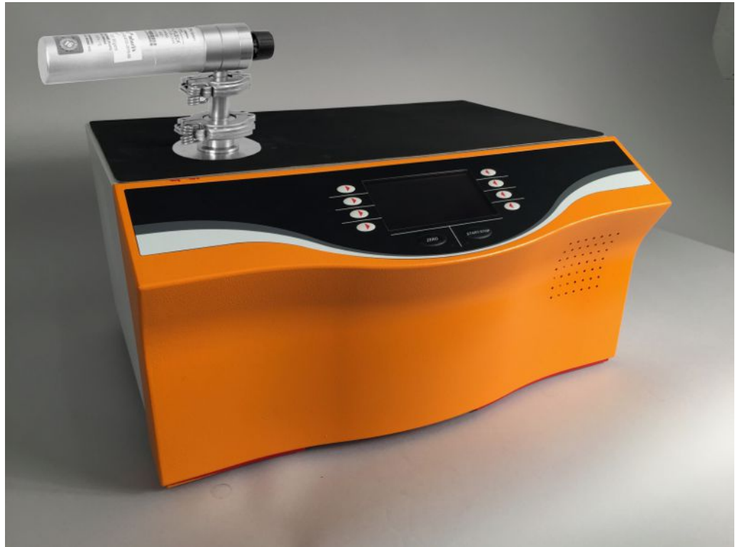
Abb. 10: Externes Prüflleck prüfen
