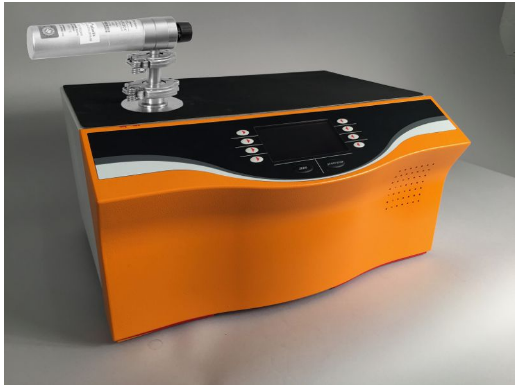
插图 15: 检查外部漏孔
