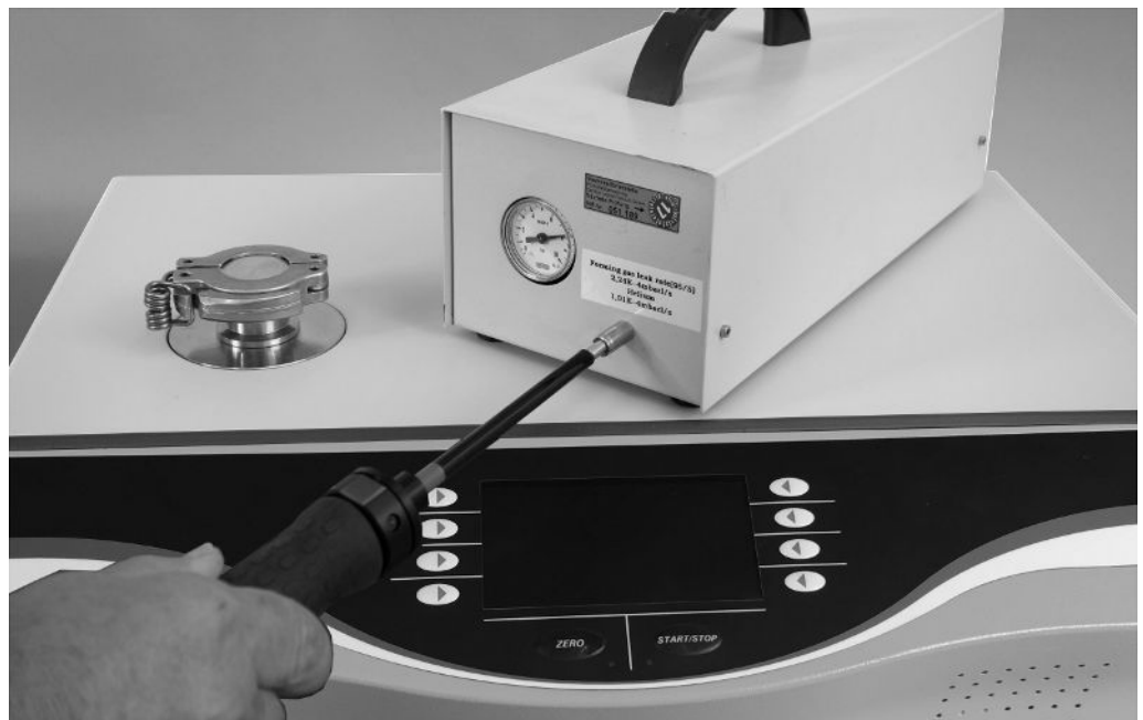
插图 17: 外部漏孔上进行嗅探检查
