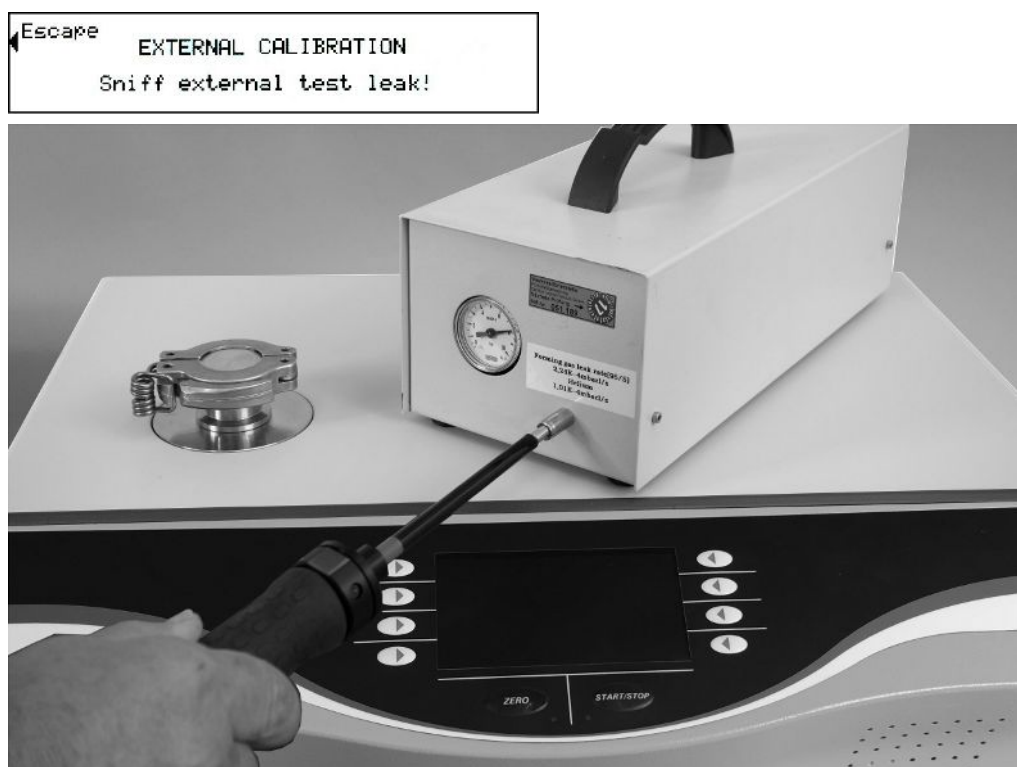
Рис. 12: Проверка с детекторной линией на внешнем контрольном течеискателе
