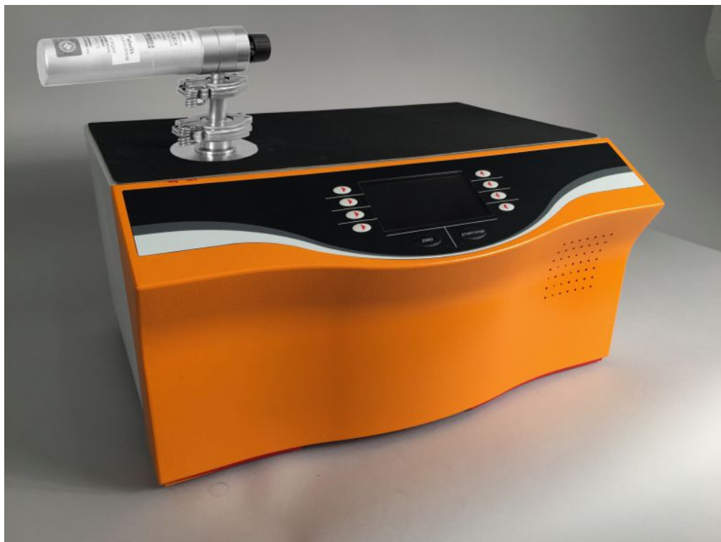
Рис. 10: Проверка внешнего контрольного течеискателя
