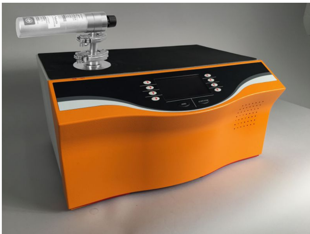
Рис. 10: Проверка внешнего контрольного течеискателя
