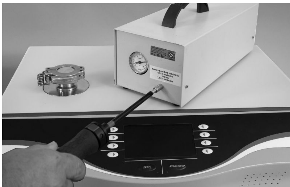
Рис. 12: Проверка с детекторной линией на внешнем контрольном течеискателе
